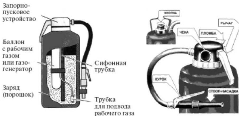
Рисунок 3 - Порошковый огнетушитель со встроенным газовым источником давления ОП-5
